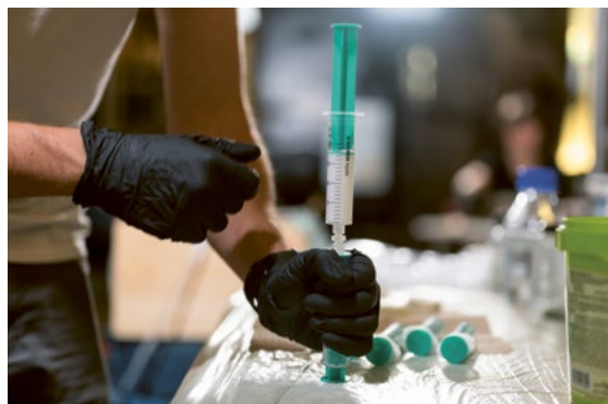
Zwei Spritzen werden aneinandergesetzt. Ein Milliliter eines Spezialtensids wird durch das wechselnde Aufziehen in die Spritzen mit Luft versetzt. Es entsteht ein stabiler dichter Schaum mit kleiner Blasengröße.
